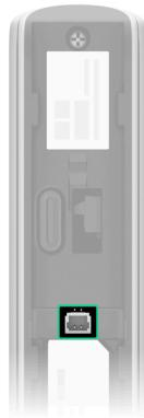
5. Activez l'option **Contact externe** dans les paramètres du dispositif.
